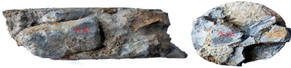
图7 地面注浆后钻孔取芯效果示意图
